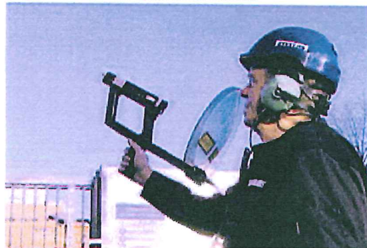
Parabolantennen på baksidan av instrumentet förstärker ultraljudet, så att det går att hitta läckor på upp till 100 meters avstånd.
